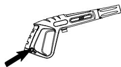
NOTA: Quando você apertar o gatilho da pistola, a força de pressão da água pressurizada exercerá uma força de recuo sobre você. Sempre segure a lança com as duas mãos e com força e em uma posição segura para evitar desestabilizar ou molhar as áreas imprevistas.
