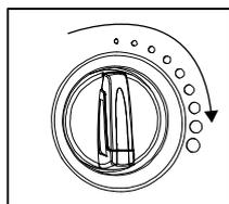
Ao operar o interruptor de ajuste de fluxo no sentido horário, a máquina aplicará um volume maior de água. E fará o oposto se se virar na direção oposta.
