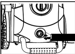
É muito importante que você verifique o status do filtro de entrada de água, uma vez que, se estiver conectado, não permitirá a entrada de água suficiente para o funcionamento correto da máquina. E se estiver com defeito, poderá permitir a passagem de impurezas na água que danificariam a bomba e o funcionamento da máquina.
