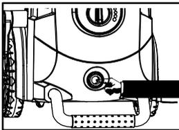
Es muy importante que verifique el estado del filtro de entrada de agua, ya que si está taponado no permitirá entrar el caudal suficiente para el correcto funcionamiento de la máquina. Y si está defectuoso, podría permitir el paso de impurezas en el agua que dañarían la bomba y el funcionamiento de la máquina.
