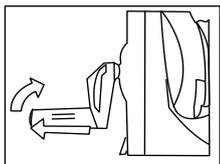
El manillar del enrollador es plegable, de tal forma que para su uso puede desplegarlo hacia abajo y cuando guarde la máquina puede recogerlo otra vez plegándolo sobre su soporte hacia dentro.
