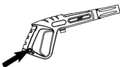
NOTA: Al apretar el gatillo de la pistola, la fuerza de empuje del agua a presión ejercerá una fuerza de retroceso sobre usted. Siempre sujete la lanza con las dos manos y con fuerza y esté en una posición segura para evitar desestabilizarse o mojar zonas no previstas.
