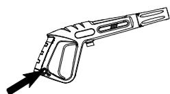
**REMARQUE:** Lorsque vous appuyez sur la gâchette du pistolet, la force de poussée de l'eau sous pression exercera une force de recul sur vous. Tenez toujours la lance avec les deux mains et avec force et soyez dans une position sûre pour éviter de déstabiliser ou de mouiller les zones non planifiées.
